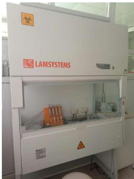
Рисунок 7. Бокс абактериальной воздушной среды БАВп-01-
