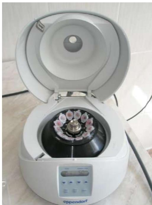
Рисунок 9. Микроцентрифуга «МиниСпин», развивающая
