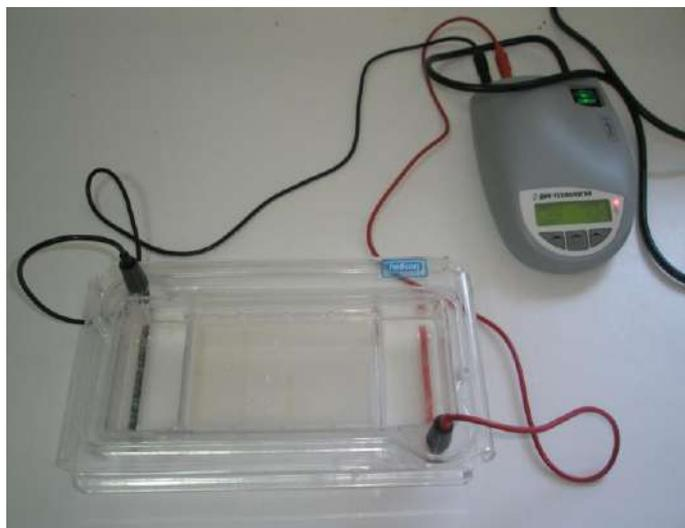
Рисунок 17. Камера для электрофореза
