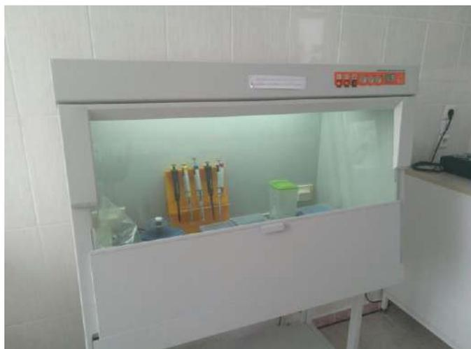
Рисунок 8. Бокс антибактериальной воздушной среды БАВ-ПЦР-
