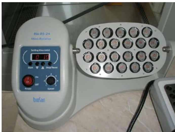
Рисунок 12. Миниротатор «BioRS-24» для перемешивания смеси в пробирках
