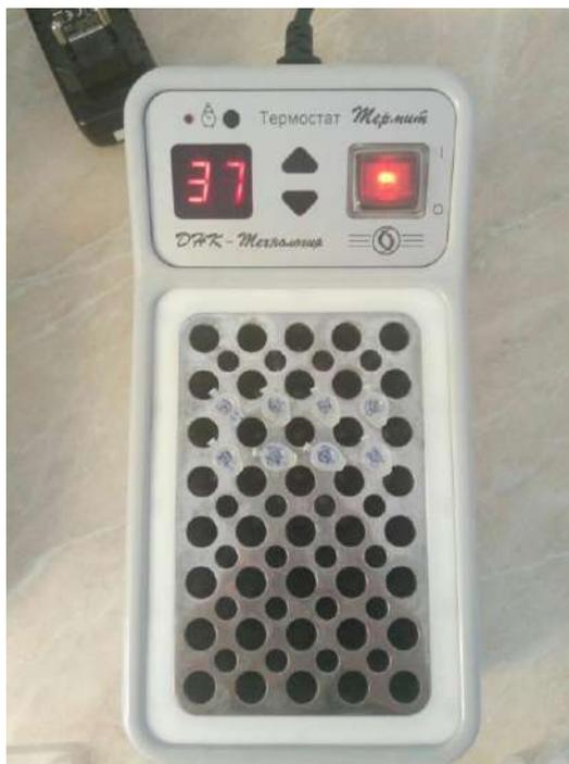
Рисунок 11. Термостат твердотельный с таймером ТТ-2 «Термит»
