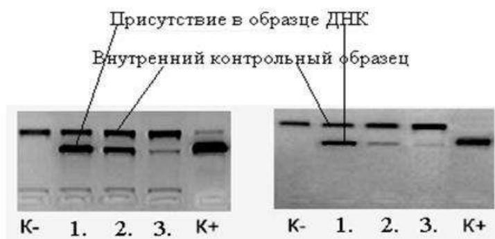
Рисунок 23. Детекция гель-электрофорез. Гелевые карманы расположены внизу. 1,2,3 один и тот же образец, но разное количество выделенной ДНК. 1- большое количество ДНК. 3-мало выделенной ДНК.
